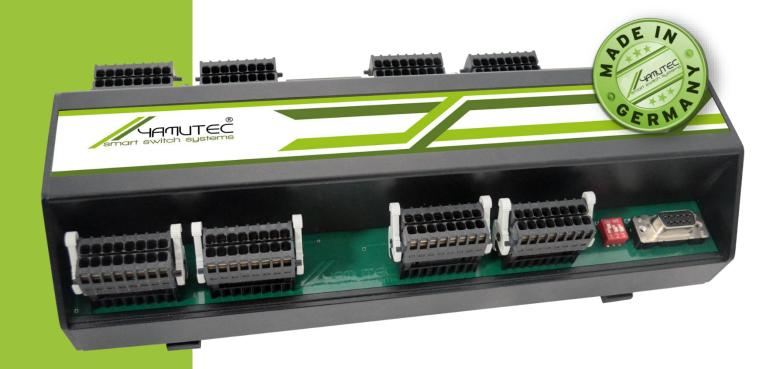
Das Yamutec® SER-HYBRID32\_3A Modul verfügt über 32 potentialfreien PCN Leistungsrelais Ausgänge und 32 Optokoppler-Eingänge. Die Ausgangsrelais bewältigen einen Schaltstrom von bis zu 3A. Dieser sorgen für eine optimale galvanische Trennung von Steuer- und Regelkreis sowie eine zuverlässige Signalübertragung. Die Optokoppler arbeiten mit Signalspannungen von 5V bis 15V und sind einsetzbar bis zu einem maximalen Eingangsstrom von 10mA.
