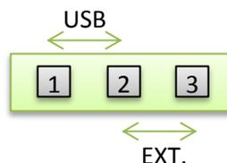
Verwenden Sie als externe Spannungsversorgung z.B. ein Steckernetzteil, das über eine stabilisierte Ausgangsspannung von 7V/DC – 24V/DC und einen Ausgangsstrom von mindestens 400 mA verfügt.
