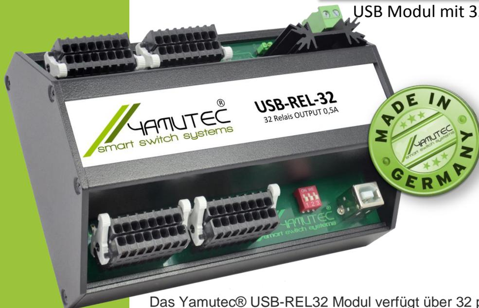
Das Yamutec<sup>®</sup> USB-REL32 Modul verfügt über 32 potentialfreien Reed Relais Ausgänge. Die Ausgangsrelais bewältigen einen Schaltstrom von bis zu 0,5A. Der PC-Anschluss erfolgt einfach und unkompliziert per Plug & Play über eine USB-Schnittstelle und benötigt keine Treiberinstallation. Über eine externe Spannungsquelle wird das Modul mit der notwendigen Betriebsspannung versorgt. Der Anschluss für die externe Spannungsversorgung erfolgt über einer 2-poligen Schraubklemme Stecker.
