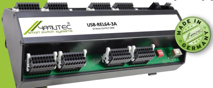
Das Yamutec® USB-REL64-3A Modul verfügt über 64 Leistungsrelais Ausgänge. Die leistungsfähigen Ausgangsrelais bewältigen einen Schaltstrom von bis zu 3A. Der PC-Anschluss erfolgt einfach und unkompliziert per Plug & Play über eine USB-Schnittstelle und benötigt keine Treiberinstallation. Über eine externe Spannungsquelle wird das Modul mit der notwendigen Betriebsspannung versorgt. Der Anschluss für die externe Spannungsversorgung erfolgt über einer 2-poligen Schraubklemme Stecker.
