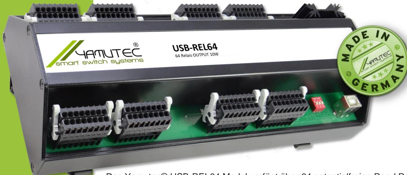
Das Yamutek<sup>®</sup> USB-REL64 Modul verfügt über 64 potentialfreien Reed Relais Ausgänge. Die Ausgangsrelais bewältigen einen Schaltstrom von bis zu 0,5A. Der PC-Anschluss erfolgt einfach und unkompliziert per Plug & Play über eine USB-Schnittstelle und benötigt keine Treiberinstallation. Über eine externe Spannungsquelle wird das Modul mit der notwendigen Betriebsspannung versorgt. Der Anschluss für die externe Spannungsversorgung erfolgt über einer 2-poligen Schraubklemme Stecker.
