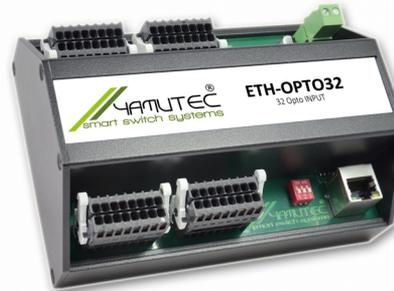
Unsere Yamutec® Optokoppler unterstützen die Kommunikation von Geräteeinheiten, zwischen denen ein erheblicher Potentialunterschied besteht durch eine effiziente galvanische Trennung des Steuerkreises vom Lastkreis. Die Ethernet Optokoppler Module werden als Schnittstelle für Steuer-, Melde- und Regeleinrichtung, wie z.B. zum Schutz der Eingangskreise von Messgeräten, eingesetzt.
