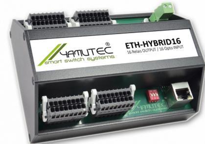
Kombinieren Sie die Vorteile der Optokoppler und Relais Module in einem Gerät! Yamutec® Ethernet Hybrid Module sind für alle Einsatzbereiche design, die neben einer galvanisch getrennten Datenübertragung, auch die Signalverstärkung und -vervielfachung verlangen.
